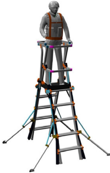
[그림 IV-26] 이동식 사다리 대체품(작업발판)의 개발 시안
