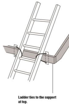
[그림 II-26] 이동식 사다리 형태 및 안전장치(WSDLI)
