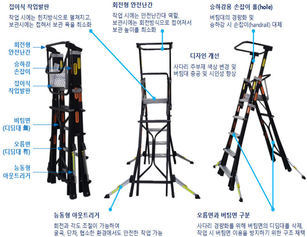
[그림 IV-33] 대체품(작업발판) 모델 시제품의 형상 및 주요 특징
