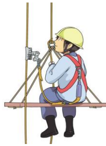
수직구멍줄 설치 및 안전대 체결
